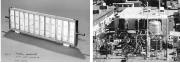
7. ábra. Karbonátoltvadékos tüzelőanyag-elem, amelyet az amerikai hadseregnek készített a Texas Instruments 1966-ban (balra) és a 250 db karbonátoltvadékos tüzelőanyag-elemmel működő, 210 kW-os erőmű, San Diego, California 1997 (jobbra).
