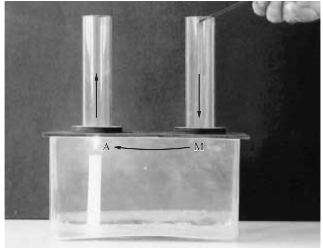
2. ábra. Konvektív áramlások kialakulásának vizsgálata (2. kísérlet)
