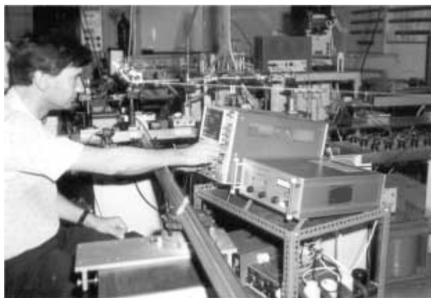
5. ábra. A gázlézer laboratórium az 1980-as években. A képen János Mibály dolgozik az üreges katódú He–Kr + lézerrel.
