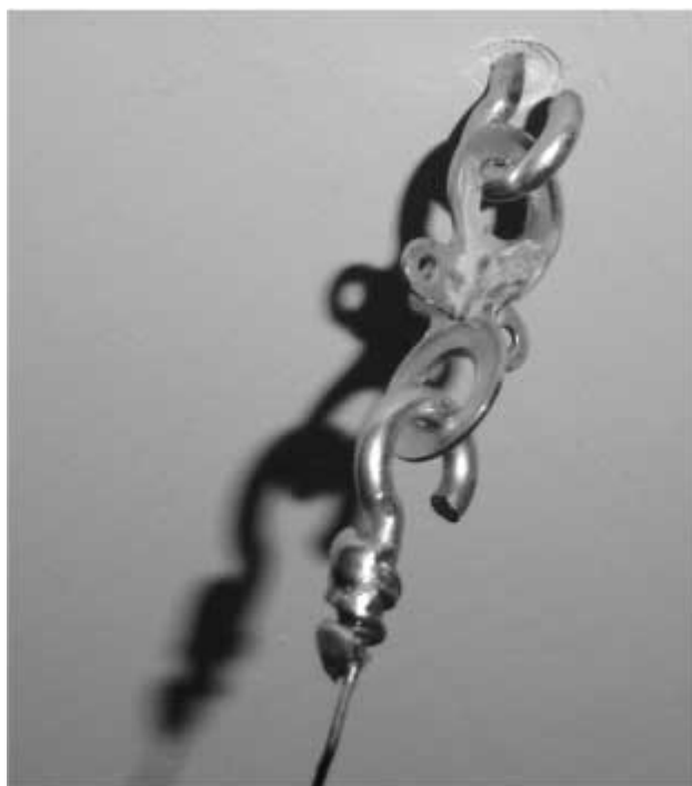
4. ábra. Cardano-féle felfüggesztés két darab alátét segítségével.
