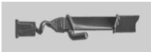
4. ábra. Egykristály-turbinalapát a „malacfarokkal”
