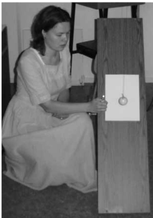
3. ábra. A nyugvó inga indítása a rögzítő fonal elégetésével.
