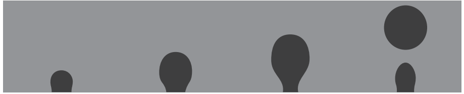
3. ábra. Falról leváló buborék rács-Boltzmann szimulációja.
