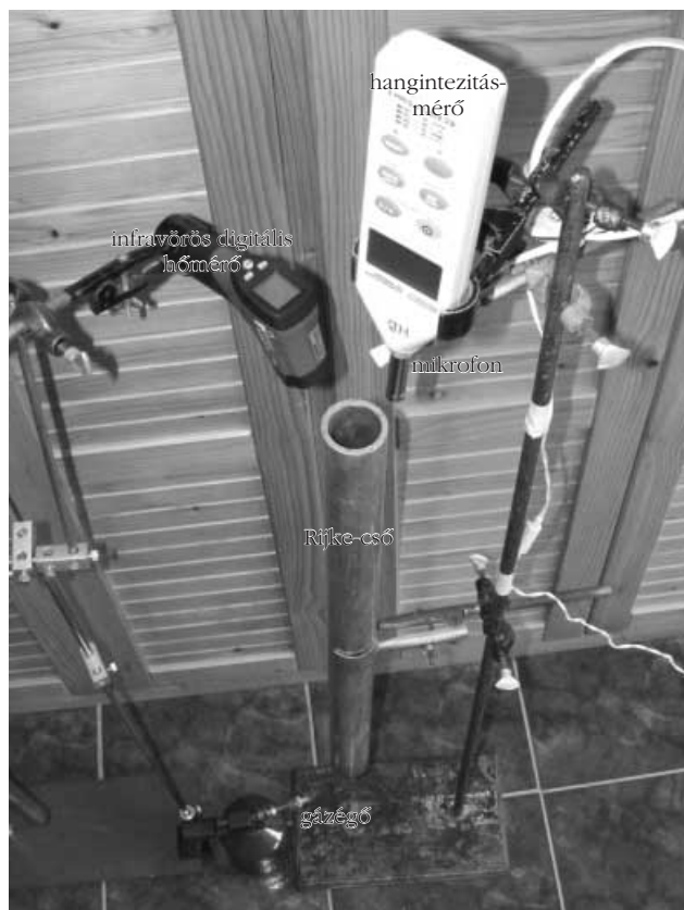
2. ábra. Rijke-cső a mérőműszerekkel együtt
