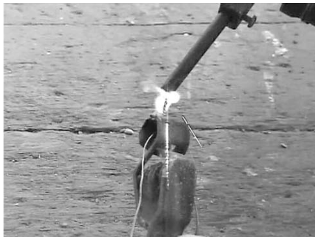
5. ábra. Ívfény a vezetékek és a szénrúd között.
