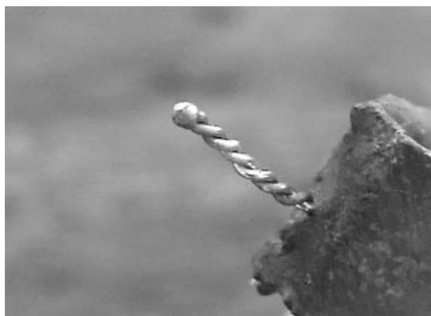
6. ábra. Az egybeolvadt két vezetékvég.
