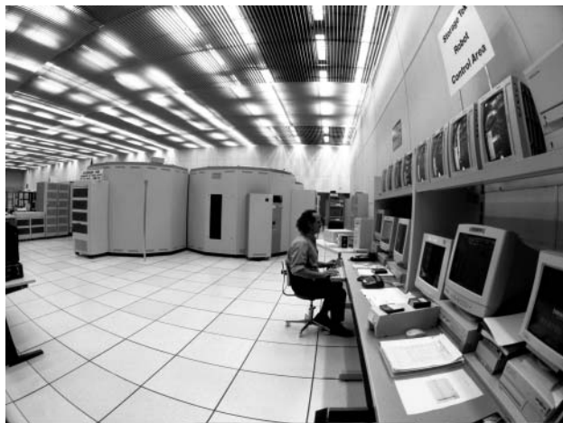
1. ábra. Robotokkal kezelt mágnesszalag-kapszulák terme a CERN-ben, 2001. © CERN
