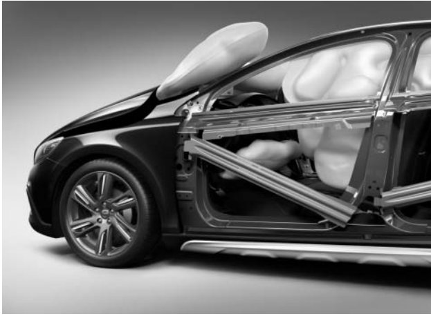
5. ábra. A temérdek, utasokat védő légszák mellett a Volvo kifejlesztette a gyalogosokat óvó külső légszákot is.
