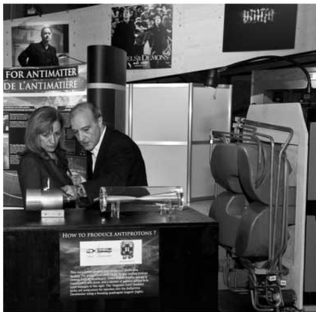
2. ábra. Antiproton keltése, ahogyan az Antiproton-lassítónál történik. A Proton-szinkrotron nagyenergiájú protonjai balról beleütkeznek a kúp alakú céltárgyba, a keletkező antiprotonokat a középső mágneses kürt gyűjti össze és a jobbra elhelyezkedő kvadrupólmágnes fókuszálja. (A CERN Angyalok és Démonok kiállításáról.)
