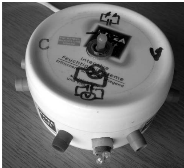
9. ábra. Az átkapcsoló gyakorlati kivitelezése
