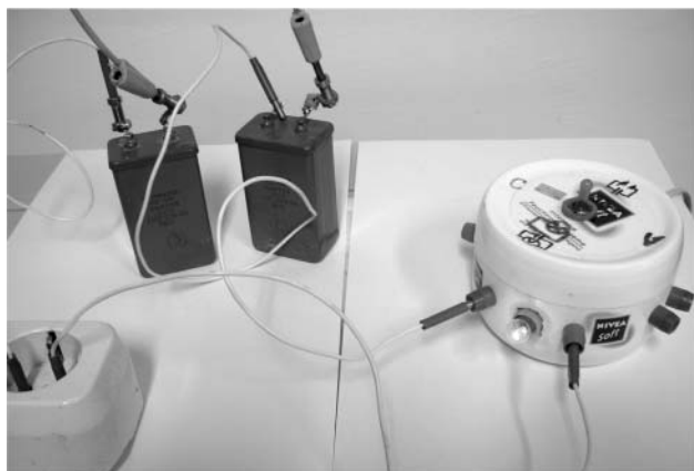
10. ábra. A kondenzátor mint ellenállás
