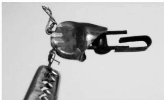
13. ábra. A gyújtó bimetal kapcsolója
