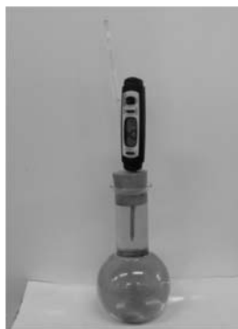
1. ábra. A víz hőtágulásának mérése: a mérőeszköz és az eredmény.
