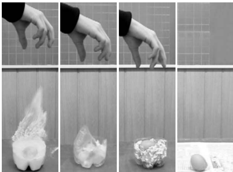
6. ábra. Ugyanazon tojással elvégzett kísérletsorozat (balról-jobbra). A tojást lisztbe, felfújt nylonzacskóba, lazán összegyűrt alufóliába és asztalra ejtettünk. A tojás csak az asztalra ejtés után repedt meg.
