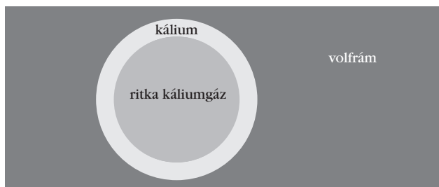
5. ábra. A volfrámba ágyazott káliumbuborék belsejének vázlata.
