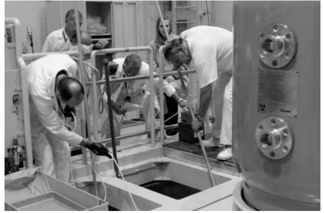
2. ábra. A kiégett fűtőelemek víz alatti betöltése a VPVR/M konténer kosarába.
