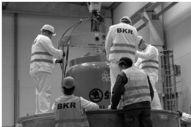
5. ábra. A VPVR/M konténer betöltése a „huzat”-ba.
