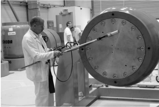
3. ábra. A betöltött VPVR/M konténer sugárvédelmi ellenőrzése.
