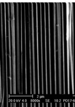
1. ábra. AAO membrán mikroszkópos képei. Balra: pórusos alumíniumoxidról készült pásztázó elektronmikroszkópos (SEM) felvétel (felülnézet). Középen: a pórusrendszer tetejének atomierő-mikroszkópos képe. Jobbra: Az alumíniumoxid-membrán keresztmetszeti SEM-képe. Előállítási körülmények: háromszori marás 1 mólos foszforsavban 195 voltban. Az első két marás által eredményezett oxidréteget 0,2 mólos krómsavval távolították el. (Gong és Zangari nyomán [27].)
