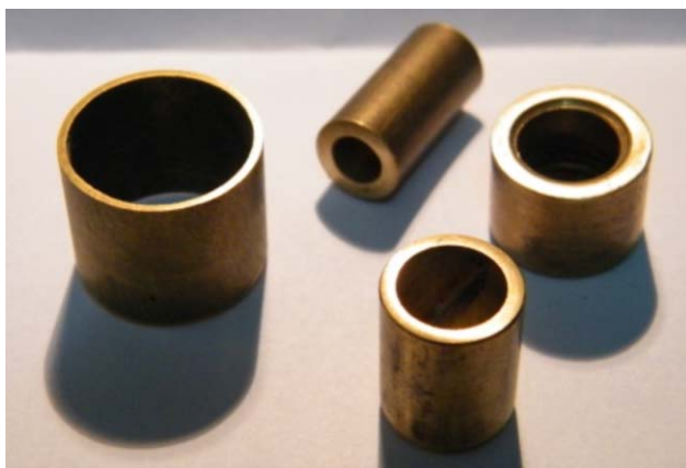
10. ábra. Rézcsövek, amelyeken keresztül az elektrofor fedeléről töltések jutnak a szigetelő felületére, kúszókisülést okozva rajta.
