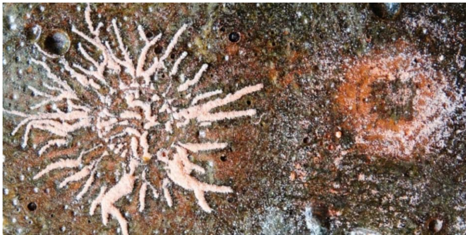
18. ábra. Lichtenberg-ábrák fémtányérra öntött zöldes színű spanyolviaszon, kén- és míniumporral.
