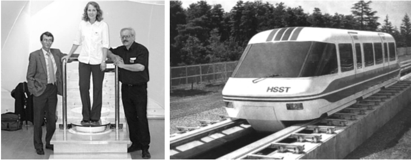
2. ábra. Megnövelt lebegtető erővel már embert is elbír (balra). Szupravezető mágnesekkel lebegtetett vonat (jobbira).
