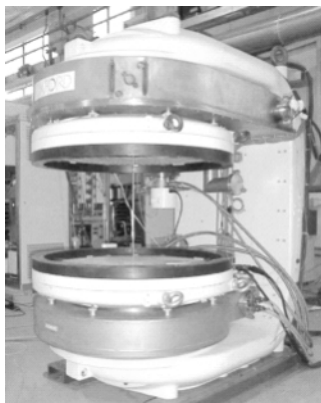
5. ábra. MHS huzalból készült mágneses rezonanciakészülék és a vele készült felvétel
