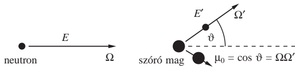
3. ábra. Neutron szóródása atommagon
