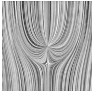
15. ábra. A Faraday- és Lenz-törvény Java-applettel megvalósított szimulációja. Egy álló állandó mágneshez egy szabadon eső, rövidebb zárt tekercs (gyűrű) közeledik. Természetesen ez csak egy pillanatfelvétel. A tekercs ellenállása változtatható, az ábra egy szupravezető gyűrű esetét mutatja. Ebben az esetben a tekercs visszapatann a mágnesről. A tekercsben folyó áram a jobb alsó sarokban lévő grafikonon látható.
