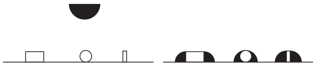
2. ábra. Az STM-tű véges görbületi sugara okozta látszólagos kiszélesedés. A bal oldali ábrán három jellegzetes domborzati alakzatot láthatunk, ezeket képezzük le az ábra tetején fekete félkörrel jelölt tűvel. A jobb oldali ábra azt mutatja, milyen vonal mentén mozog a tű.
