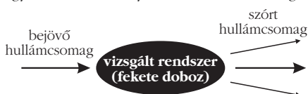
4. ábra. A hullámcsomag-dinamikai módszer elvi vázlata. A bejövő hullámcsomag szóródik a vizsgált rendszeren, a rendszer tulajdonságaira a szórt hullámcsomag tulajdonságaiból következtetünk. A kimenő hullámcsomagot ábrázoló három, különböző vastagságú nyíl azt szimbolizálja, hogy a különböző irányokba különböző erősségű a szórás.
