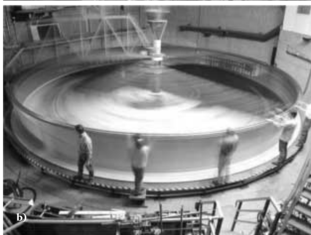
7. ábra. A Coriolis-platform. a) Kísélet előkészítése közben. b) Forgó állapotban (a kísérletet végzők a platformon dolgoznak) [www.coriolis-legi.com/coriolis-turntable.htm].
