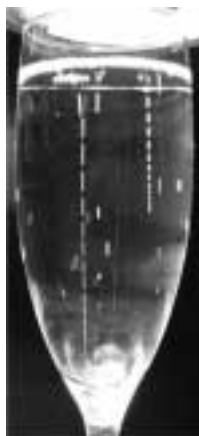
8. ábra. Buborék mozgásának vizsgálata nyomkép alapján
