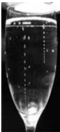
8. ábra. Buborék mozgásának vizsgálata nyomkép alapján
