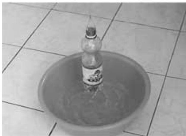
17. ábra. A kiömlő víz hatására forgásba jön a műanyag palack
