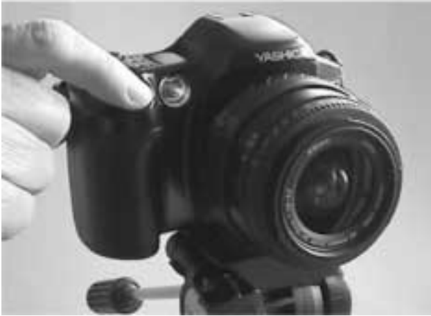
2. ábra. Fényképezőgép infravörös távolságmérővel
