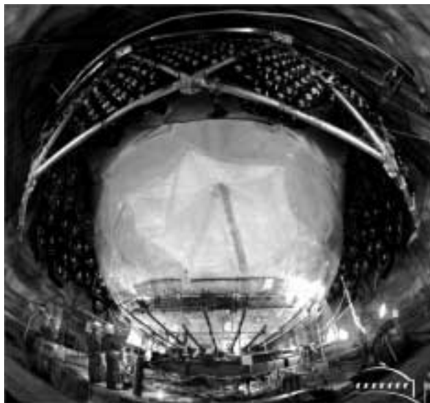
4. ábra. A Sudbury Neutrino Observatory (Kanada) 1000 t nehézvízzel feltöltött tartálya, amelyben a Naphól érkező neutrínók bármely fajtája reakciót vált ki, így lehetőség van a teljes neutrínófluxus észlelésére.
