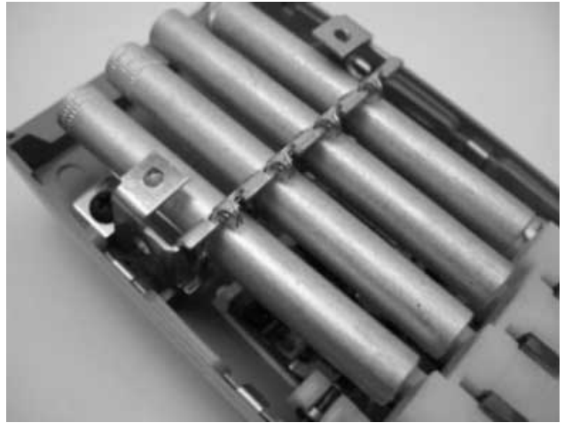
3. ábra. A Robert Adler konstruálta első, ultrahangos TV-távírányító
