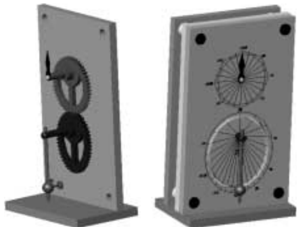
13. ábra. Az elvileg egzakt cometarium-mechanizmus CAD-modellje
