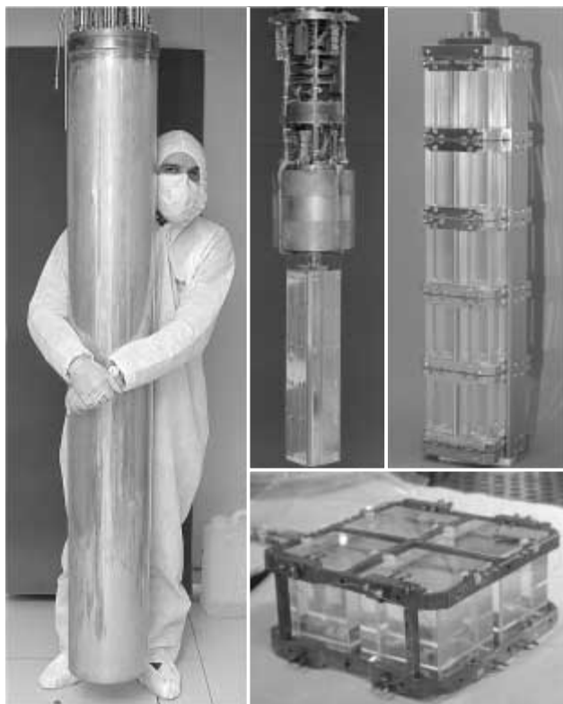
8. ábra. CUORICINO, a legnagyobb működő kriogenikus detektorrendszer és részei
