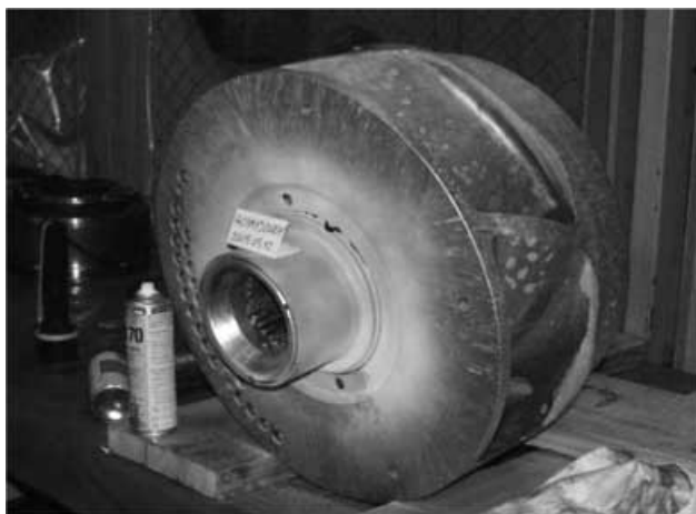
2. ábra. A fő keringtető szivattyú járókerekeinek ellenőrzése a gyártóműben.
