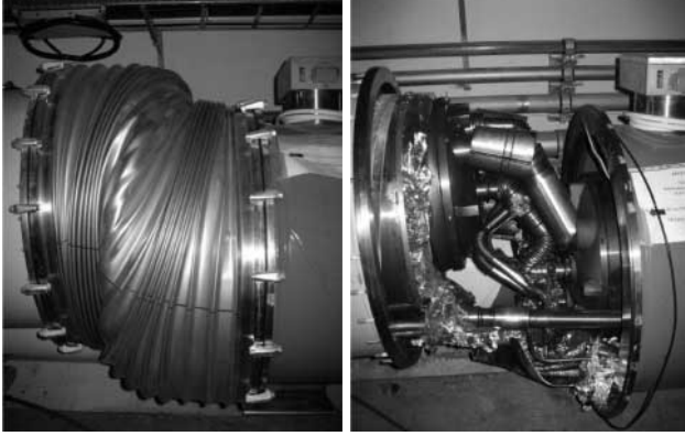
6. ábra. LHC-mágnesek tönkrement csatlakozása a 2008. szeptember 19-i baleset után, a mágnesek megnyitása előtt és után.
