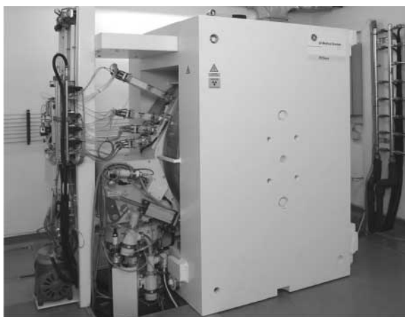
9. ábra. A PET-Trace orvosi ciklotron távlati képe a DEOEC PET centrumban (balra). A targetkamrák régiója Pótári Norbert gyártásért felelős vegyészrel (jobbra).
