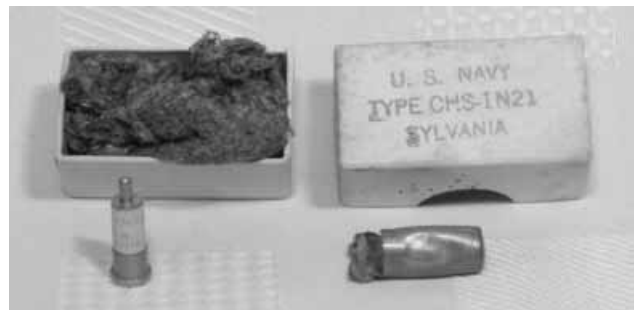
14. ábra. Második világháborús egyenirányító dióda a nagyfrekvenciás radarokhoz.
