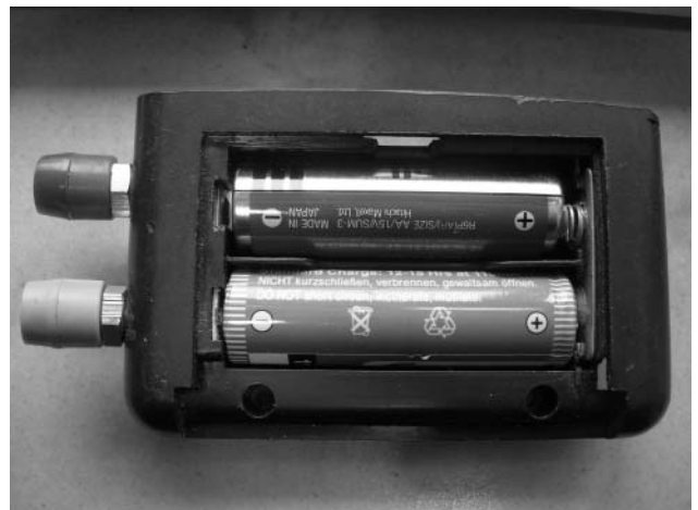
9. ábra. Szembekapcsolt elemekkel kisfeszültséget állíthatunk elő
