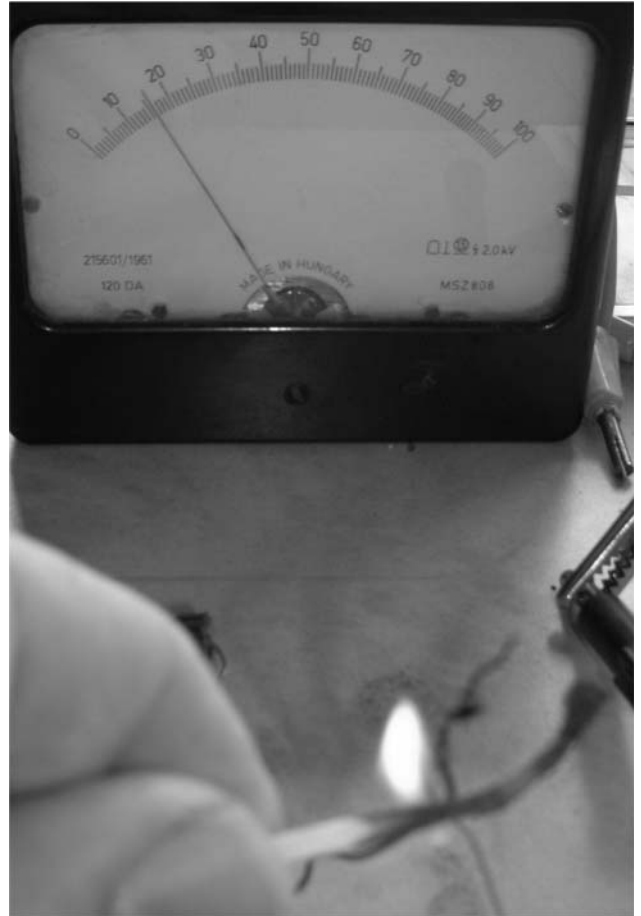
3. ábra. A termoelem működése
