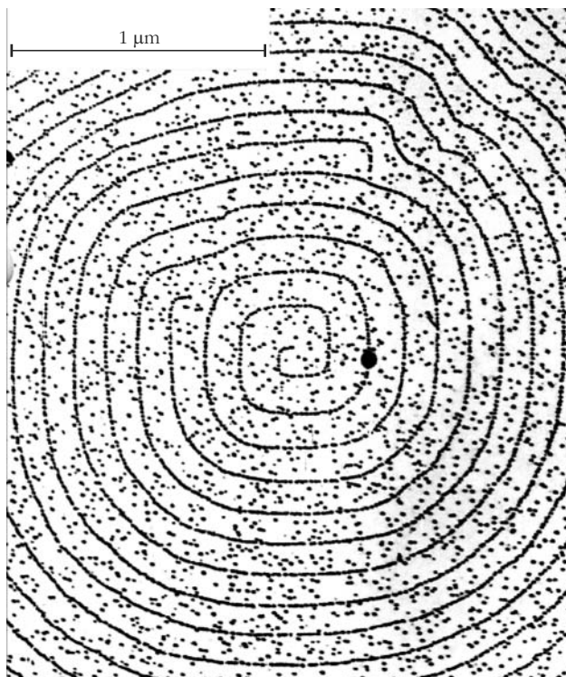
3. ábra. NaCl (100) lapján b = (a/2)[110] Burgers-vektorú csavardiszlokáció kibukkanási pontja körül kialakult egyatomos magasságú, Au-dekorált körspirál leépülési lépcsősor. ([13]-ban a 11. fotó.)
