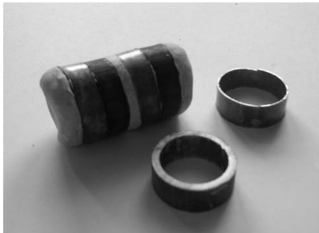
5. ábra. Két-két vas- és rézcsődarabból kialakított cella.
