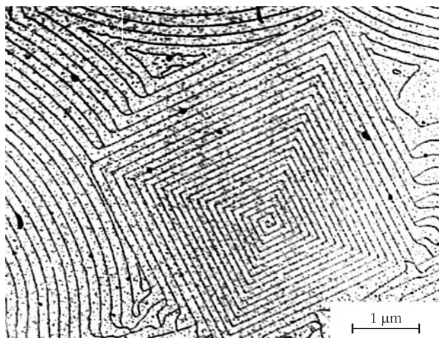
4. ábra. NaCl (100) lapján b = a[100] Burgers-vektorú csavardiszlokáció kibukkanási pontja körül kialakult kétatomos magasságú, Au-dekorált négyzetes spirál leépülési lépcsősor. ([13]-ban a 4. fotó részlete.)
