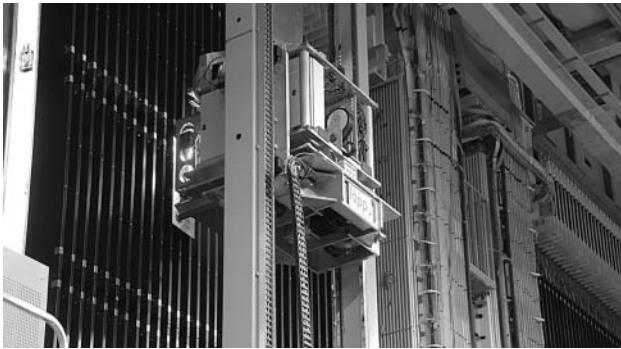
4. ábra. Az érdeklődésre számot tartó eseményt tartalmazó „téglát” kiszedő – és az üres helyet újból feltöltő – automata manipulátor.
