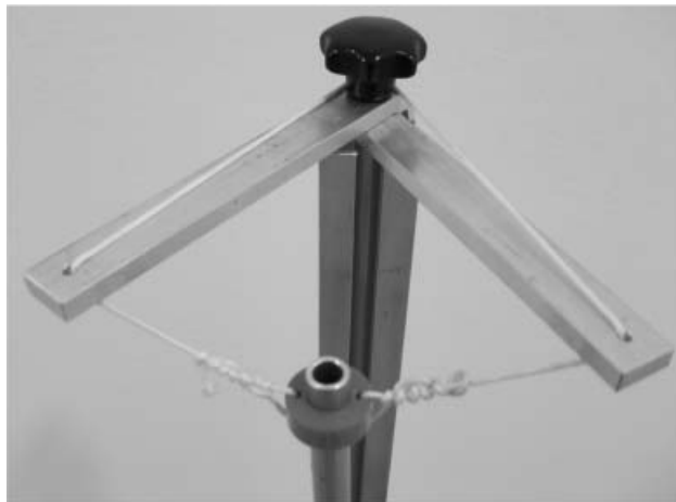
1. ábra. A cső felfüggesztésének egy módja.
