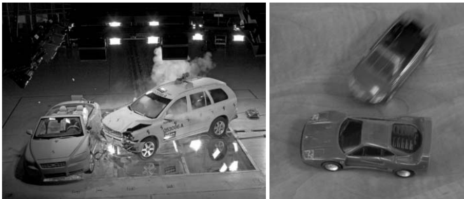
5. ábra. Valóságos és játékautók kísérleti ütköztetése.
