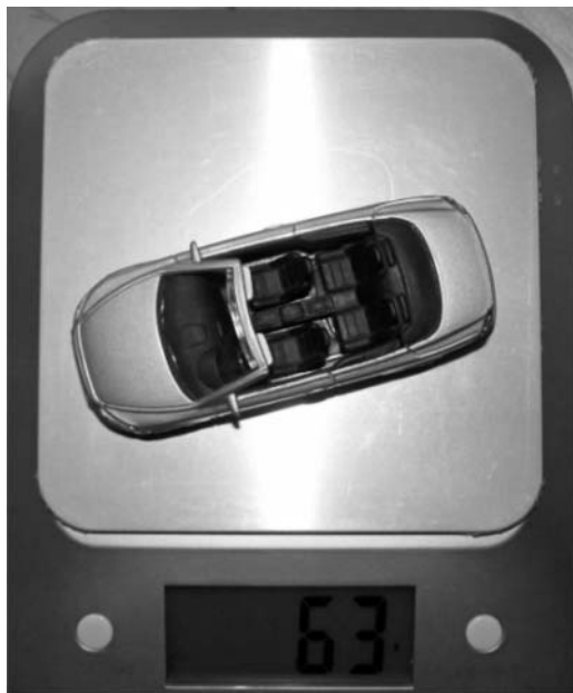
3. ábra. A játékautó szélességét, hosszúságát és lemeztvastagságát tolómérővel, a tömegét digitális mérleggel mértük meg.
