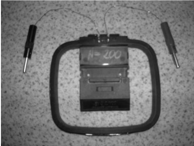
13. ábra. A „hangszóró” tekercse
