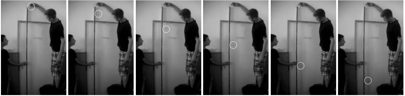
3. ábra. Szabadesés vizsgálata (a golyó pillanatnyi helye körrel kiemelve). Az azonos időközökben felvett képeket egymás mellé rakva szépen kirajzolódik a négyzetes üttörvény.
