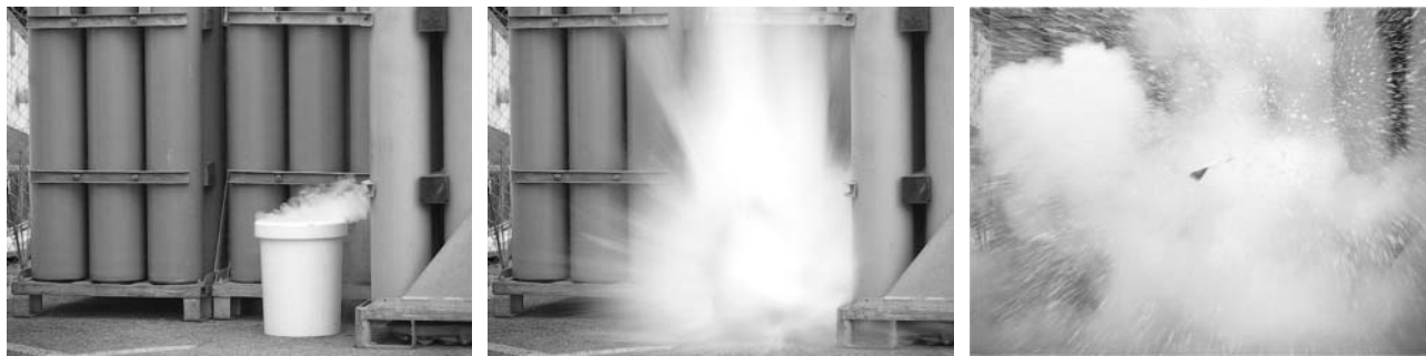
2. ábra. Robbantási kísérlet – második, fejlettebb módszer.
