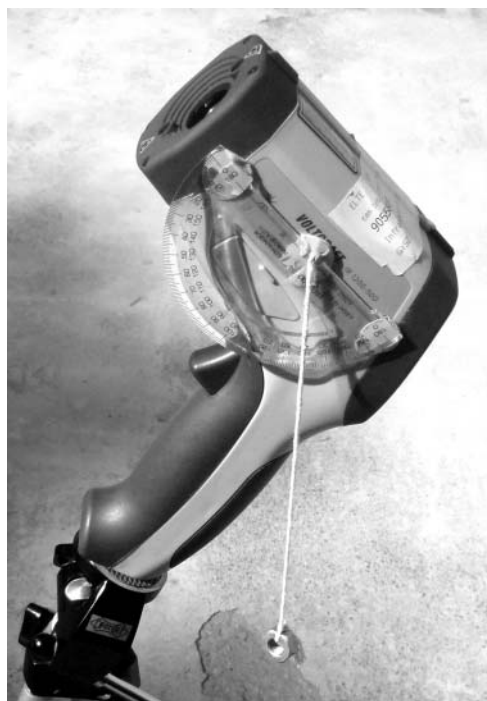
1. ábra. A hőmérő az irány beállítására szolgáló szögmérővel.
