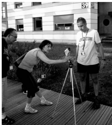
2. ábra. Mérés az infravörös hőmérővel (balra) és párhuzamos mérés a hőkamerával és az IR hőmérővel (jobbra).
