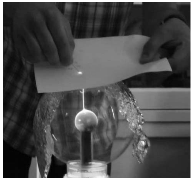
3. kép. Plazmagömbre alufólia, szigetelő és tüvel kisülés.
