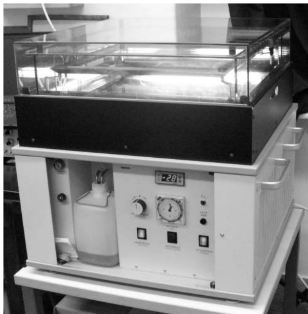
1. ábra. A PHYWE gyártmányú diffúziós ködkamra.
