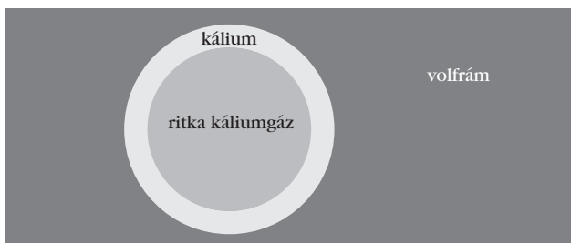
5. ábra. A volfrámba ágyazott káliumbuborék belsejének vázlata.
