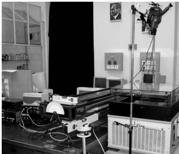
1. ábra. Mérési összeállítás a müonok megfigyelésére.
