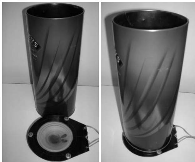
4. ábra. Akusztikus rezonátor.
