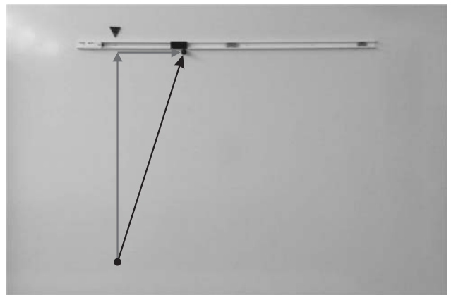
13. ábra. Az eredő elmozdulás ( \Delta y = 3 \cdot \Delta x ).
