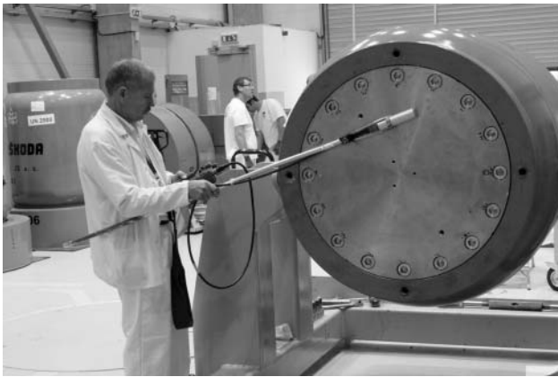
3. ábra. A betöltött VPVR/M konténer sugárvédelmi ellenőrzése.
